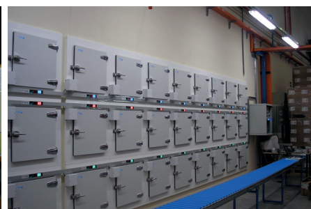
Izquierda: display de zona dónde se muestra que la zona está cerrada. Este display se suele usar para identificar al operario que va a trabajar en la zona. Además, permite confirmar con qué bulto se está trabajando y qué color se le asigna al operario para luego encender los displays de ubicación con ese color. Derecha: parecido a las jaulas, pero con neveras. Sólo se abren cuando se hace picking para no romper la cadena de frío.
