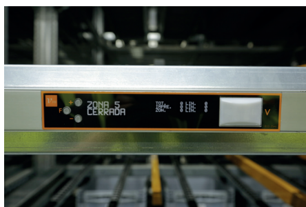
Izquierda: display de zona dónde se muestra que la zona está cerrada. Este display se suele usar para identificar al operario que va a trabajar en la zona. Además, permite confirmar con qué bulto se está trabajando y qué color se le asigna al operario para luego encender los displays de ubicación con ese color. Derecha: parecido a las jaulas, pero con neveras. Sólo se abren cuando se hace picking para no romper la cadena de frío.
