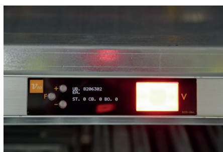
Izquierda: displays en jaulas donde se guardan estupefacientes. Derecha: display de ubicación dónde se muestra el código de la ubicación y la cantidad de stock que actualmente tiene en total y en boca. La boca es la cantidad de la primera caja que se encuentra en el frente.
