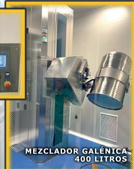
IBC SECCIÓN CIRCULAR HP
