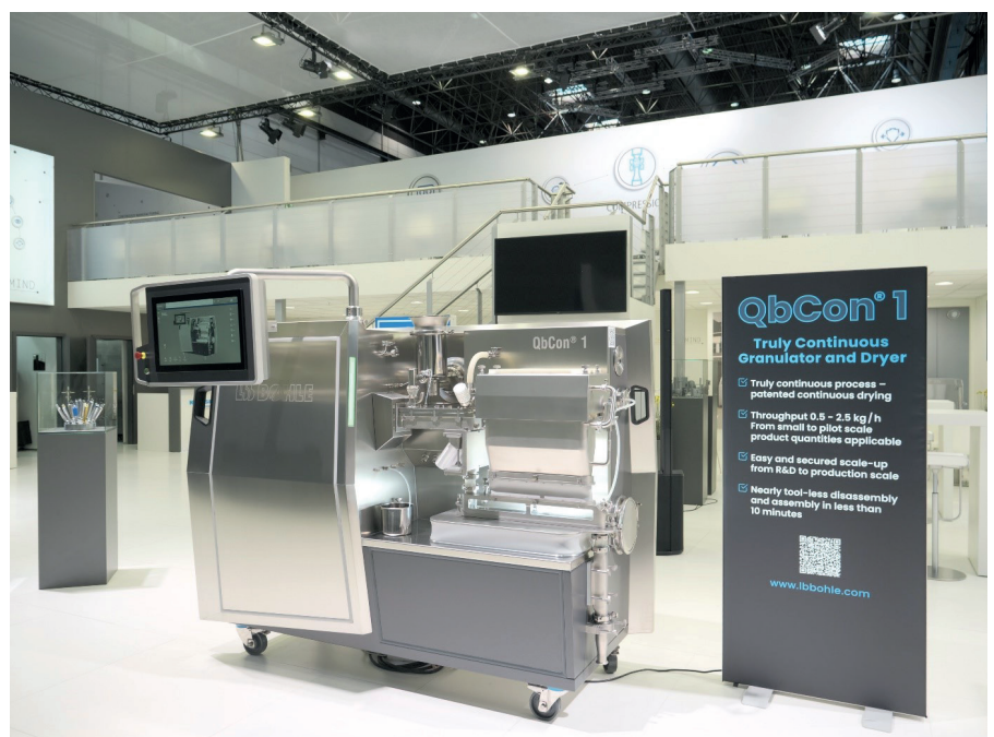
Figura 2 El secado en lecho fluido patentado garantiza el flujo de material desde la materia prima hasta los gránulos secos en funcionamiento continuo cerrado. El filtro puede limpiarse de forma totalmente automática durante el secado.
