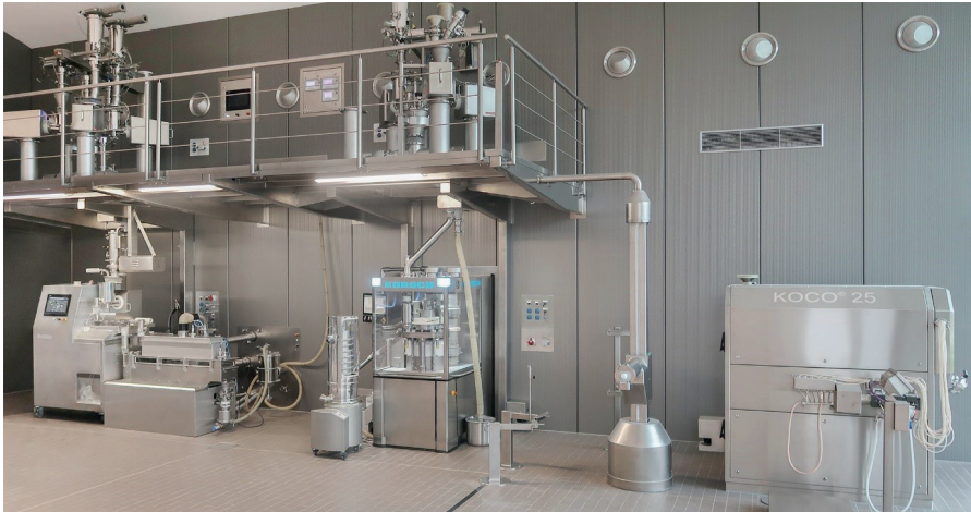
Figura 1: Fabricación Continua mediante Granulación vía Húmeda - QbCon
