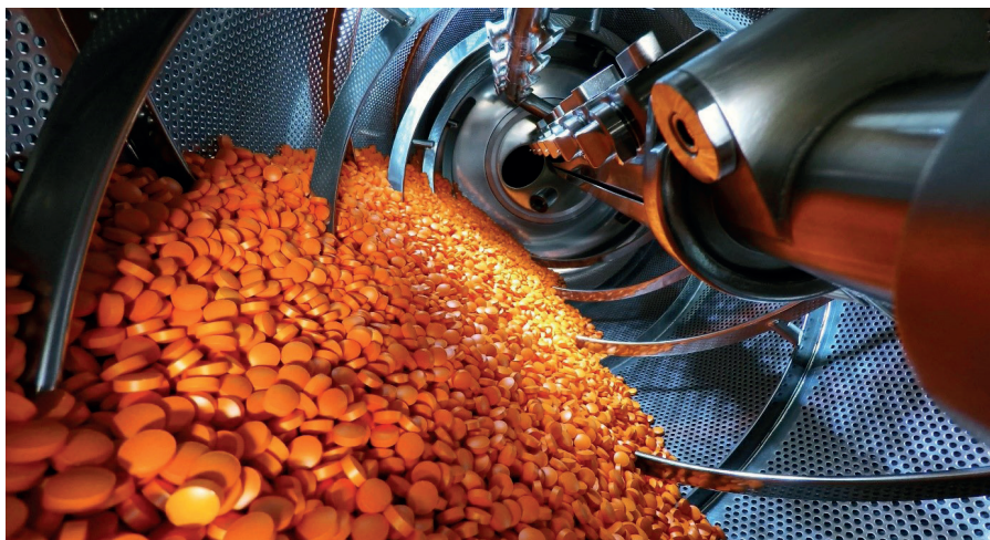
Figura 3 Vista recubridor continuo. Con dispositivo Raman ayuda al operario en determinar el fin del recubrimiento.
