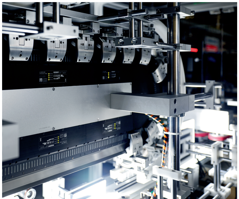
XTS ha permitido a Shinva Medical duplicar el rendimiento de inspección de su nueva máquina de inspección de frascos farmacéuticos llenos de líquido, así como reducir la longitud de la máquina a la mitad. Foto: © Beckhoff
