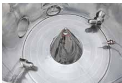
Figure 2: Bohle Uni Cone BUC® con boquillas de pulverización tangenciales dentro de un BFS 30
