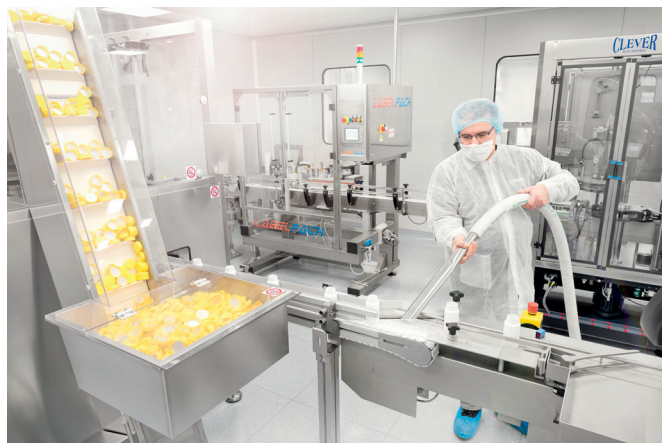
Operario aspirando línea de producción garantizando higiene y control de partículas
