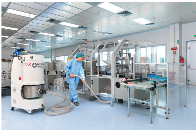
Operario controlando la contaminación del entorno con una Nilfisk VHW421
