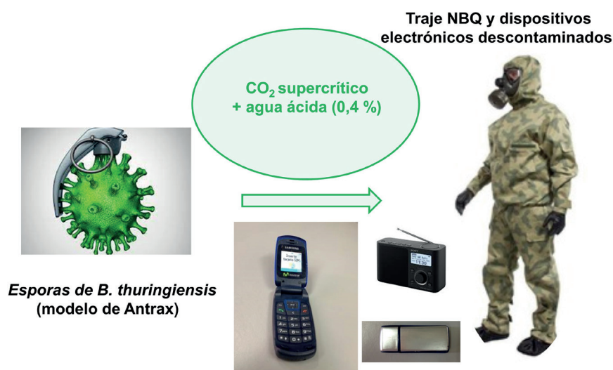
Figura 3. Descontaminación biológica de trajes de combatiente NBQ y dispositivos electrónicos mediante CO 2 sc mezclado con agua ligeramente ácida.
