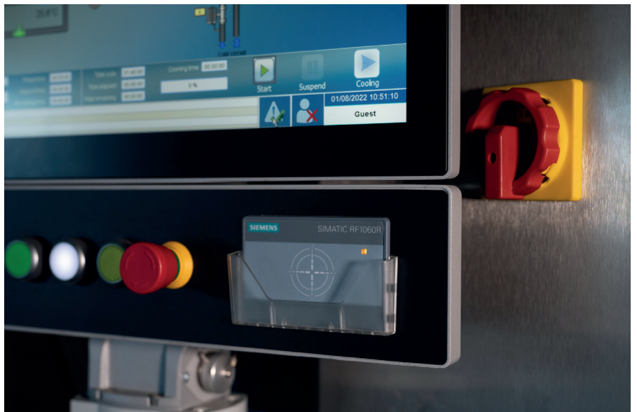
La identificación del usuario con RFID es especialmente cómoda y permite la trazabilidad personalizada de todos los procedimientos operativos.
