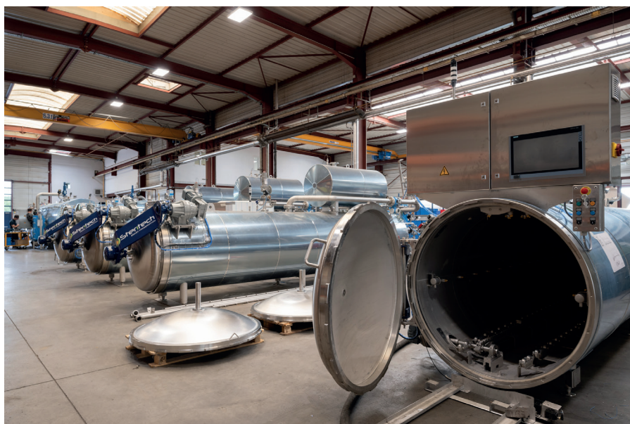
Una parte del portafolio de soluciones son autoclaves para la pasteurización y la esterilización de diferentes productos y envases.
