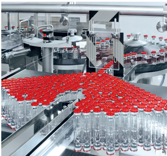
El cargador ME8081 de Bausch+Ströbel puede utilizarse en una gran variedad de aplicaciones, como el almacenamiento de ampollas, cartuchos y viales con precisión de recuento. Foto: © Beckhoff.
