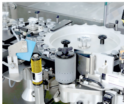
El método de manipulación de los viales dentro de la etiquetadora está diseñado para garantizar que no resulten dañados ni el objeto ni la etiqueta aplicada, gracias a funciones avanzadas como el control de movimiento de alto rendimiento. Foto: © Beckhoff.
