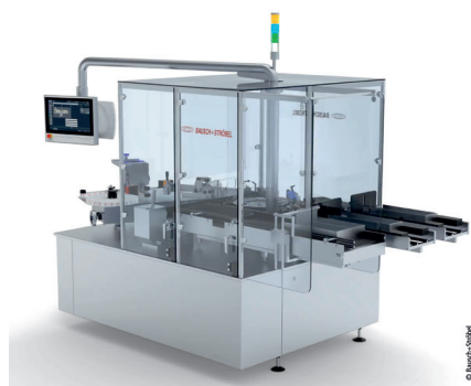
La nueva etiquetadora ESA1025 combina todos los servoejes en un controlador TwinCAT central. Foto: © Beckhoff.
