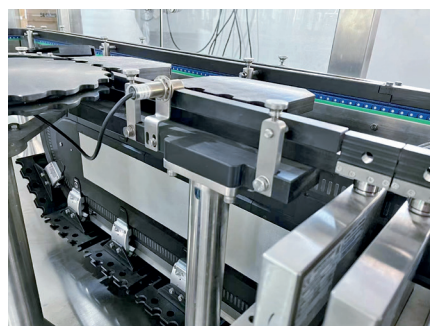
Shanghai Yinghua aumenta la capacidad de llenado de sus sistemas de polvos farmacéuticos a 450 viales por minuto con el sistema de transporte lineal XTS. Foto: © Shanghai Yinghua
