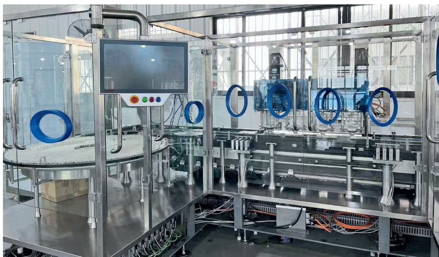
Shanghai Yinghua aumenta la capacidad de llenado de sus sistemas de polvos farmacéuticos a 450 viales por minuto con el sistema de transporte lineal XTS. Foto: © Shanghai Yinghua
