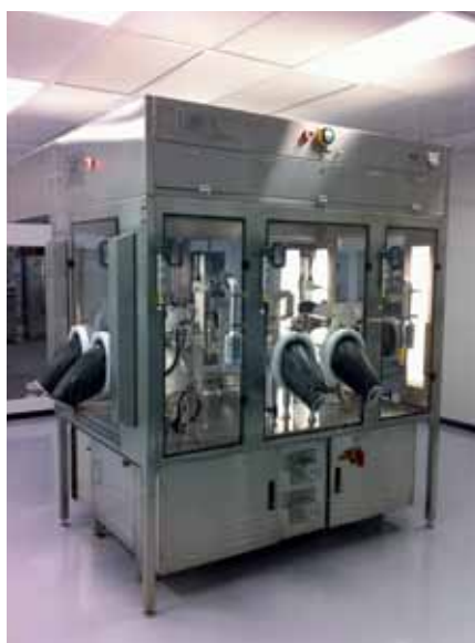
Foto 3. ANSI/RIA R15.06-1999 unidad de robot compatible seguridad RABS que protege al operador del sistema de robot y protege al producto de la contaminación originada por el operador. (Cortesía de Automated Systems of Tacoma)
