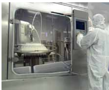
Foto 1. Aislador aséptico con un Stäubli Stericlean, un brazo de robot de seis ejes que es compatible con la fase de esterilización con peróxido de hidrógeno en fase vapor. (Cortesía de Stäubli Robotics)
