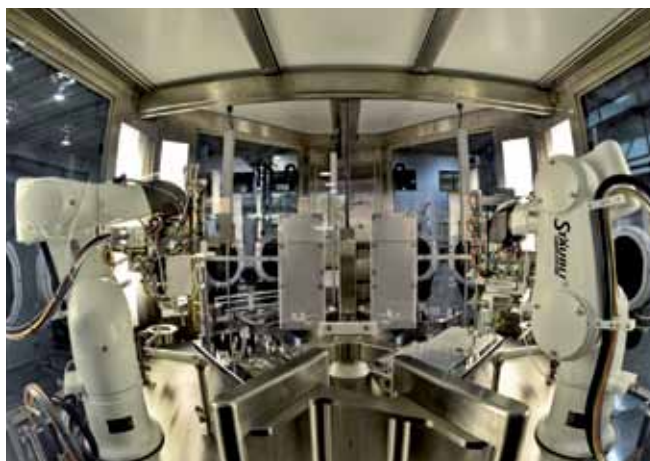
Foto 2. Célula robótica con sistema de llenado aséptico utiliza dos Stäubli Stericlean guiados por visión. (Cortesía de Automated Systems of Tacoma, Inc.)
