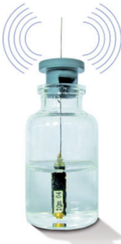
Figura 3. Sensor TEMPRIS colocado en un vial.
