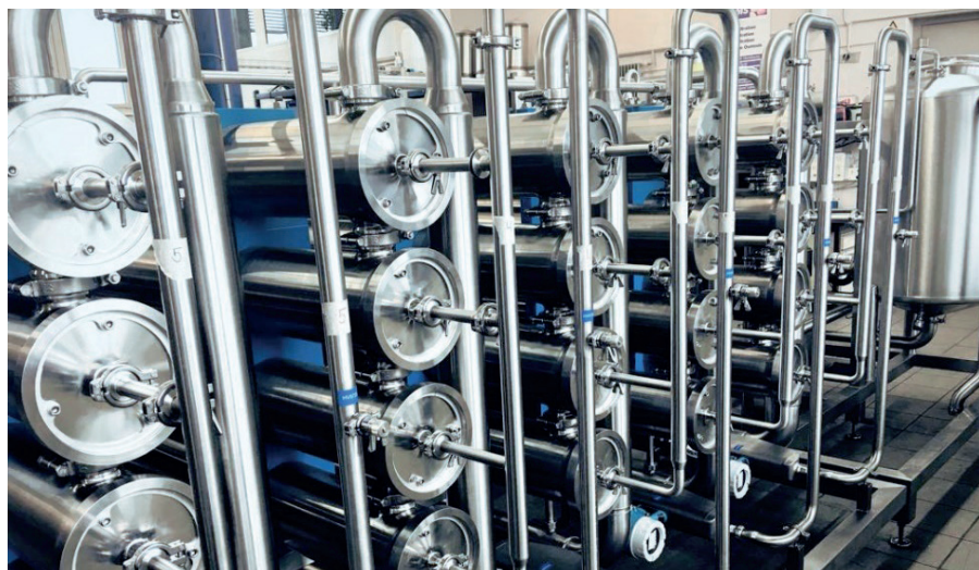
Figura 1. Sistema de ósmosis inversa sanitizable por agua caliente. Fuente: MMS AG Urdorf Suiza.
