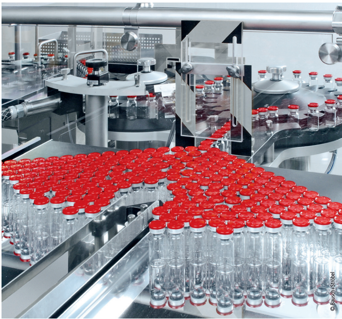
El cargador ME8081 de Bausch+Ströbel puede utilizarse en una gran variedad de aplicaciones, como el almacenamiento de ampollas, cartuchos y viales con precisión de recuento. Foto: © Bausch+Ströbel
