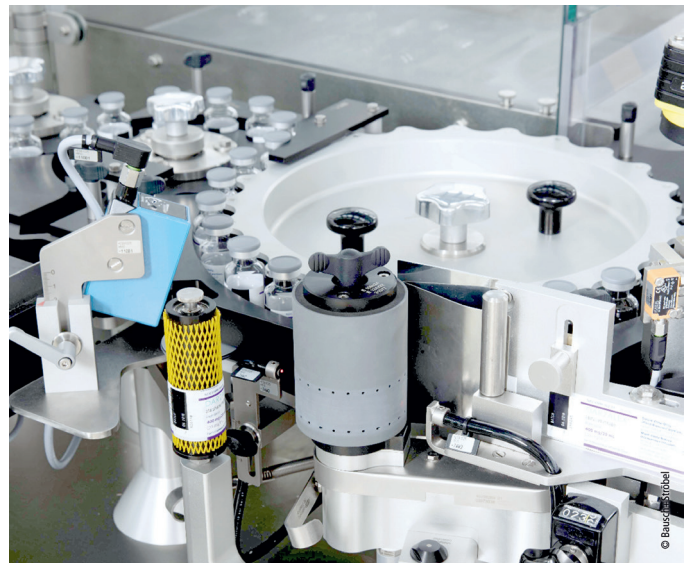
La nueva etiquetadora ESA1025 combina todos los servoejes en un controlador TwinCAT central. Foto: © Bausch+Ströbel
