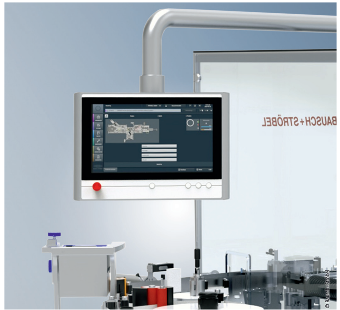
El panel de control multitáctil CP3918 con pantalla de 18,5 pulgadas se instala en un brazo de montaje y facilita el manejo de la etiquetadora ESA1025. Foto: © Bausch+Ströbel
